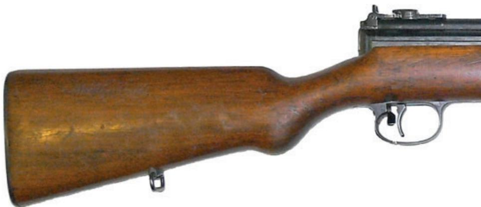
*После неудач в конкурсах 1930-1931 гг. Ф. В. Токарев взялся за создание новой автоматической винтовки. Главными её отличиями от предыдущих винтовок с газоотводной автоматикой было размещение газовой камеры над стволом и применение отъёмного коробчатого магазина. Работу над этой винтовкой Токарев завершил в 1932 г., а в следующем году на её базе создал усовершенствованную винтовку 1933 г.*
